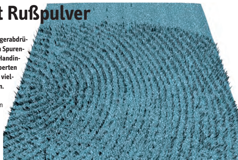
Darstellung eines mit einem kontaktlosen hochauflösenden 3D-Oberflächenmessgerät erfassten latenten Fingerabdrucks. Aufnahme: Marcus Leich
