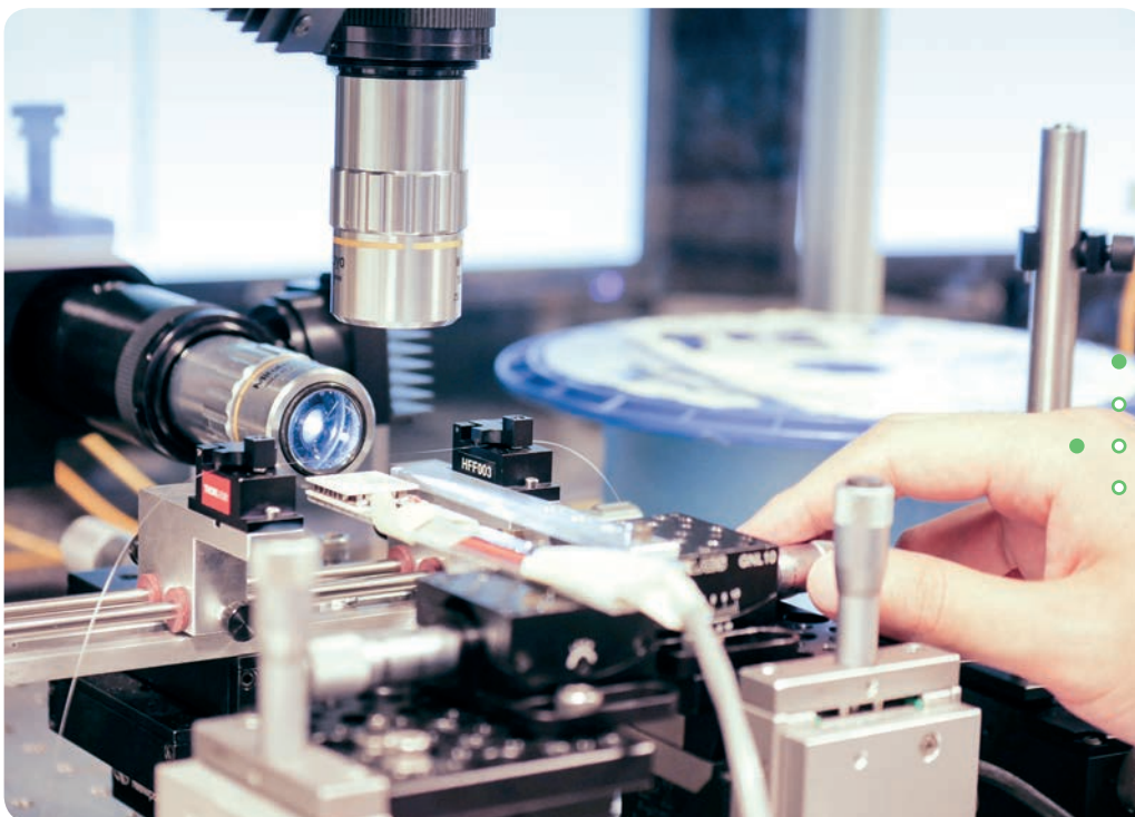
Aufbau zum Vermessen eines optischen Mikroresonators Foto: Washington University
