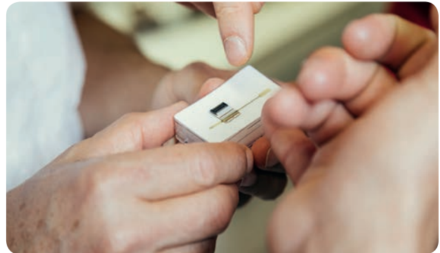
Mikroelektrodenarray mit integrierten \mu LEDs (CortiGrid/Optrode) auf einem künstlichen Gehirnphantom Foto: neuralIDE
