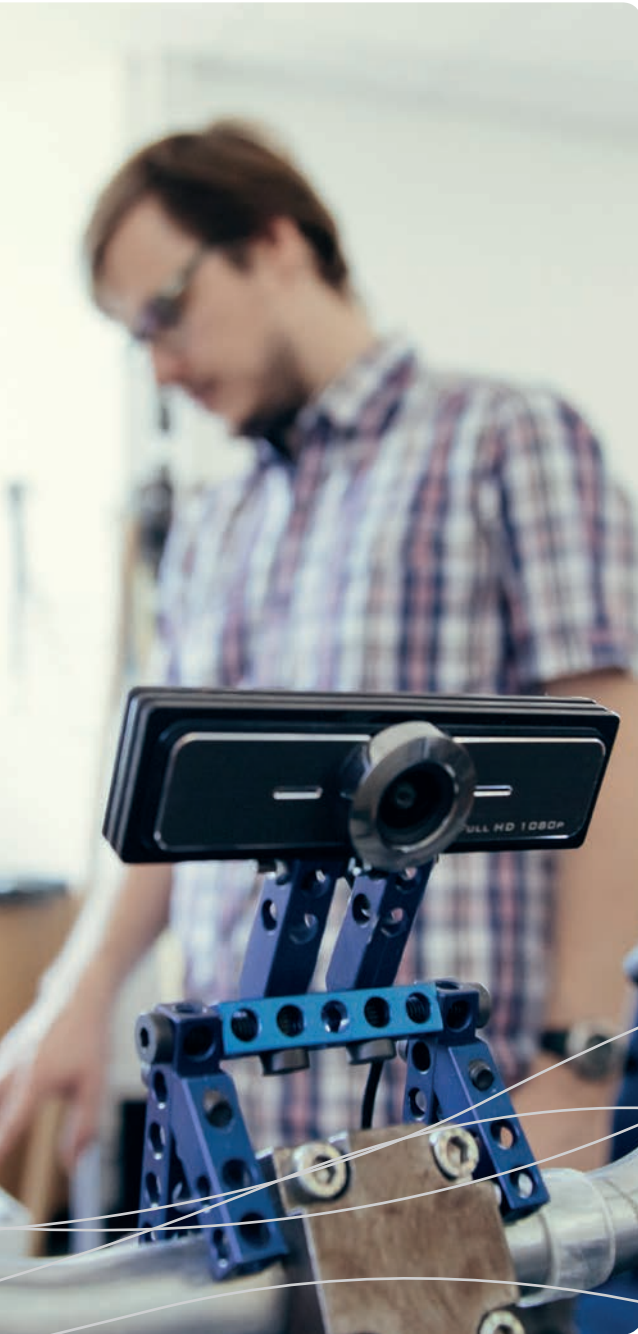
Einrichtung der Frontkamera zur Fahrbahnerkennung im Labor Foto: Harald Krieg
