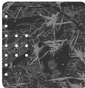
Mikrostruktur einer Chrom-Hafnium-Bor-Legierung Bild: Volodymyr Bolbut I. Bogomol, Manja Krüger
