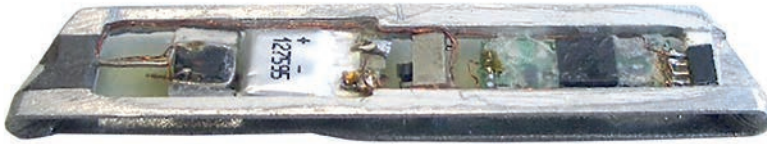
Beispielhafter Slot-Skimmer zum Ausspähen von Kartendaten Bildquelle: Bundeskriminalamt
