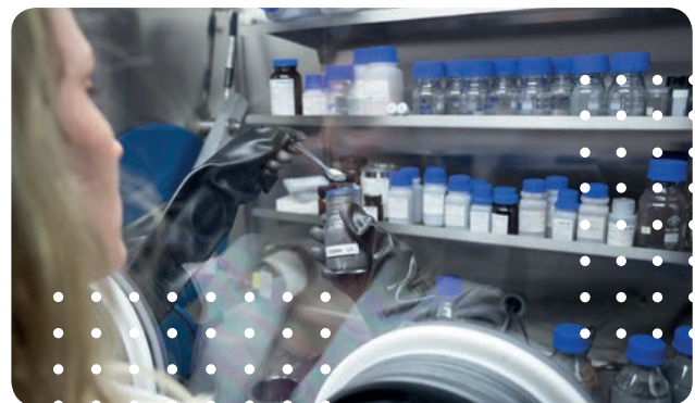
An der Handschuhbox werden die neuen Legierungen unter Sauerstoffausschluss vorgemischt Foto: Stefan Berger
