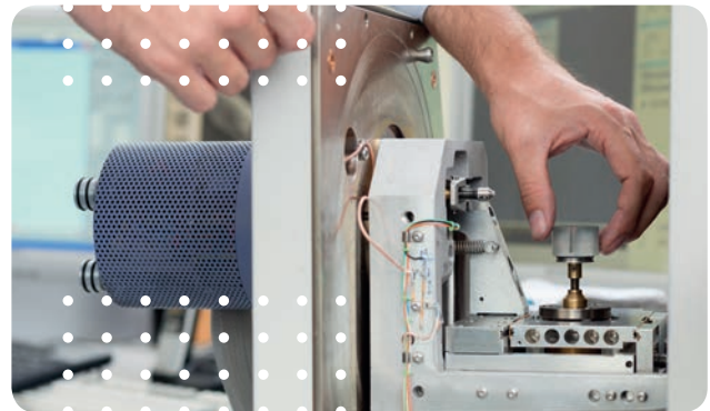
Vorbereitung einer rasterelektronenmikroskopischen Untersuchung der Mikrostruktur Foto: Stefan Berger
