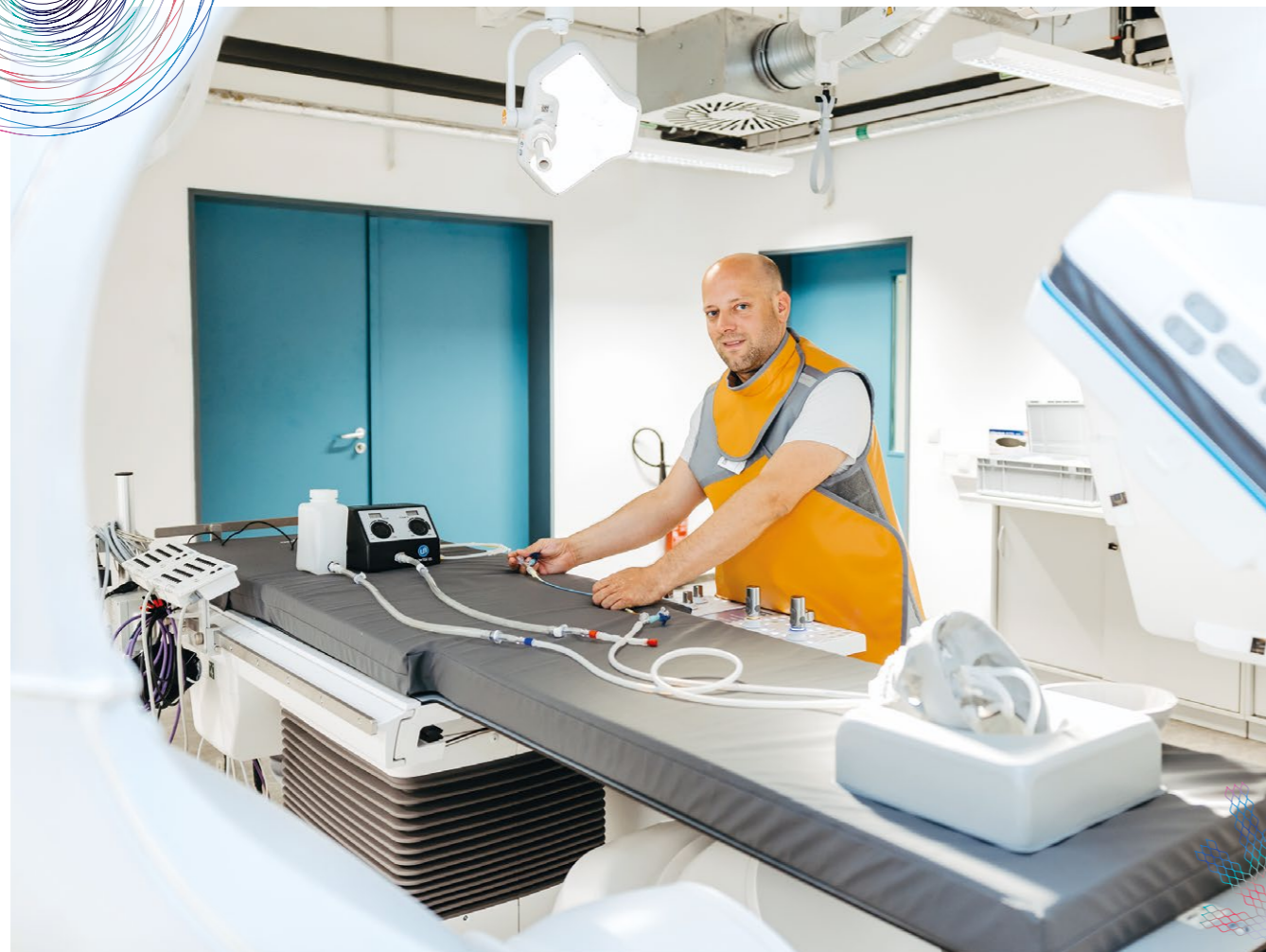
In-vitro Messung eines Flow-Diverter-Stents am STIMULATE-C-Bogen-CT. Prof. Dr. med. Daniel Behme, Chefarzt der Neuroradiologie am Magdeburger Universitätsklinikum, leitet das klinische Teilarbeitspaket im SOFINA-Projekt. Foto: Jana Dünnhaupt
