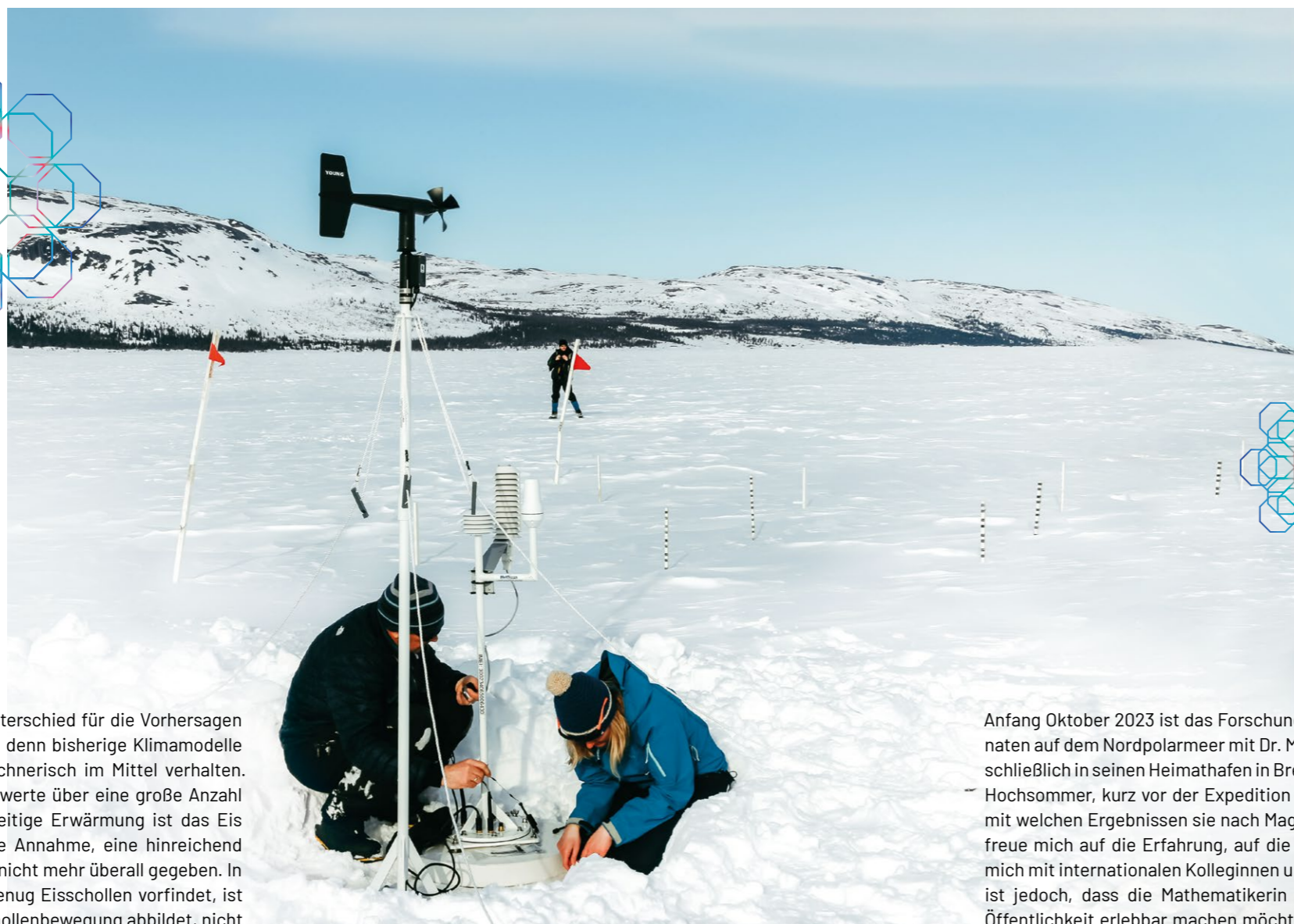
Installation einer Wetterstation Foto: Bruno Tremblay
