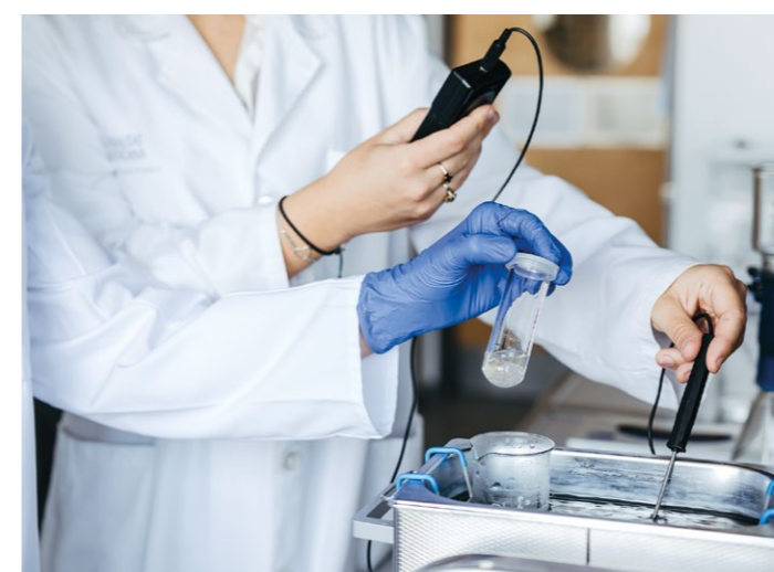
Oben: Prof. Dr.-Ing. Kai Sundmacher Foto: Stefan Deutsch/ Max-Planck-Institut Magdeburg Unten: Kontrolle der Temperatur des Ultraschallbades, in dem Polyamid 6 aufgelöst wird Foto: Jana Dünnhaupt
