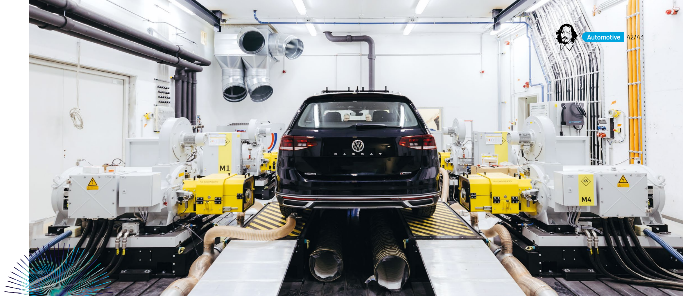
Der Gesamtfahrzeugprüfstand („Road-to-Rig-Prüfstand“) erlaubt die vollumfängliche Nachbildung sämtlicher Fahr Szenarien und Belastungszustände des Antriebsstrangs. Hierdurch kann ein weites Spektrum von standardisierten Prüfzyklen bis zu fahrdynamisch kritischen Einzelmanövern nachgebildet werden. Foto: Jana Dünnhaupt
